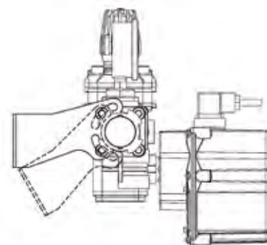
**Raccordement rapide RAPID FIT pour la composition modulaire du distributeur. Disponible soit dans les versions manuelles que motorisées.**
